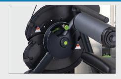
Das Doppelscheibensystem gewährleistet dauerhafte Spannung der Stahlseile und verbessert die Biomechanik
